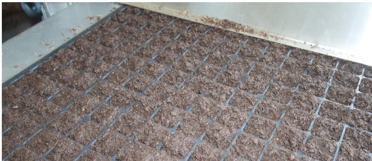
ANT2 podczas pracy z tacą miękką z zagęszczeniem wibracyjnym
