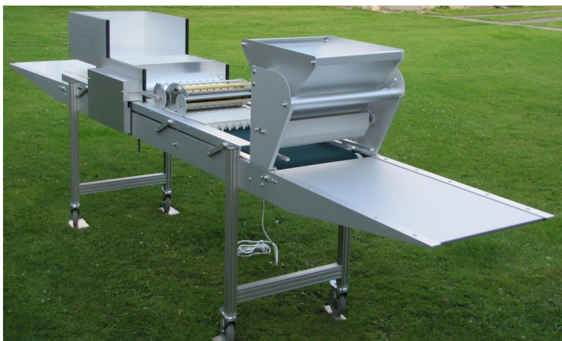
Linia VP605 wersja podstawowa w wykonaniu z anodowanego aluminium oraz stali nierdzewnej.
