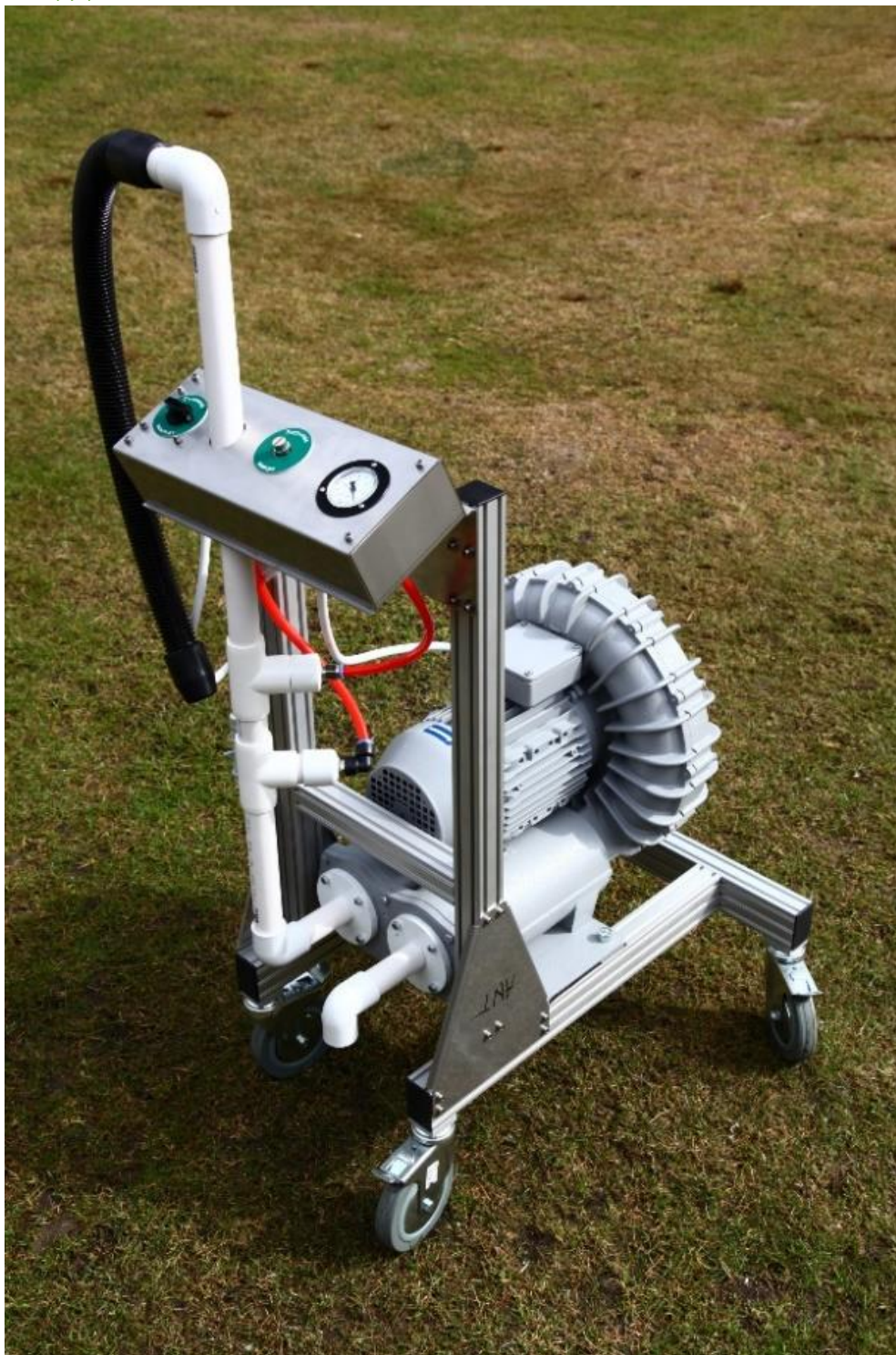
Pompa boczno kanałowa do zasilania siewników pneumatycznych PB2
