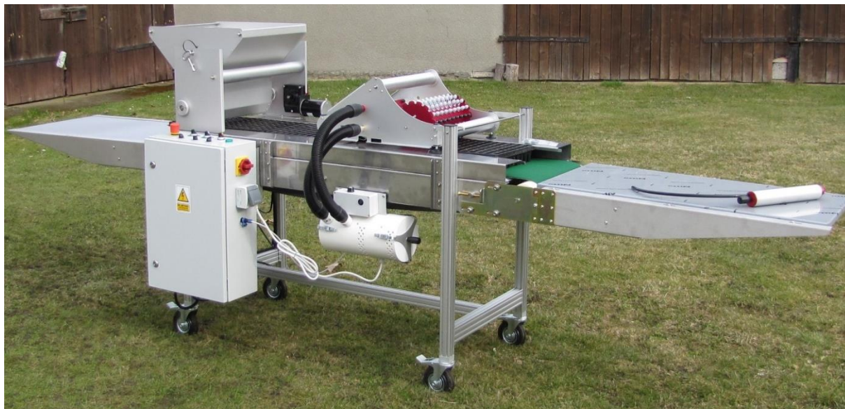
Siewnik 855L/104 zamontowany na linii wysiewającej z rozsiewaczem perlitu oraz podłączoną pompą powietrza.
