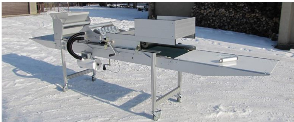
Linia VP605 wersja podstawowa w wykonaniu z anodowanego aluminium oraz stali nierdzewnej.
