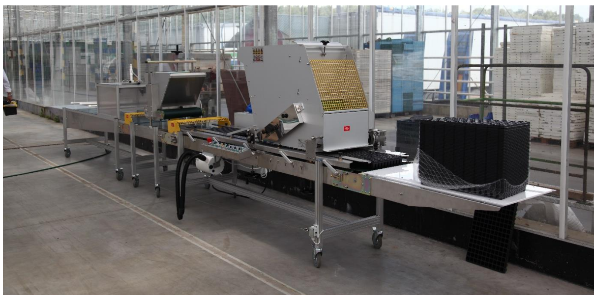
ANT5 – kompozycja z modułem głównym: napełniająco-wysiewnym, modułem nawadniającym oraz rozsiewaczem perlitu
